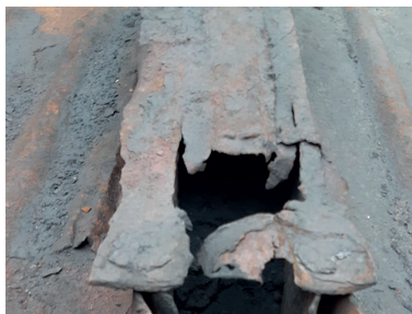
Рис. 2. Зруйнована шворнева балка вагона
