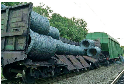
Рис. 1. Схід вагонів поїзда через руйнування торцевої стіни вагона
