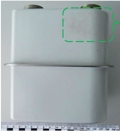
Рис. 10. Загальний вигляд лічильника з виділеною топографією слідів механічного впливу стороннього (іх) предмета (ів) на задній правій з переходом на бокову поверхню кришки корпусу лічильника газу
