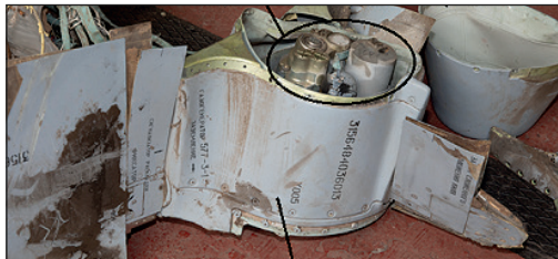
Рис. 5. Марковальні позначення на обшивці хвостового відсіку КР Х-101
