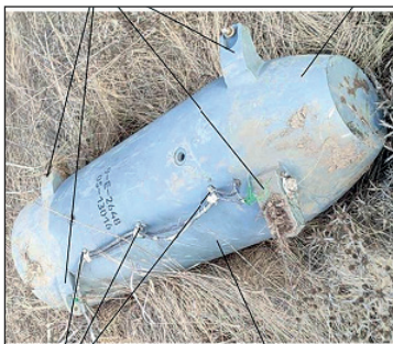
Рис. 11. Марковальні позначення на бойовій частині КР Х-101
