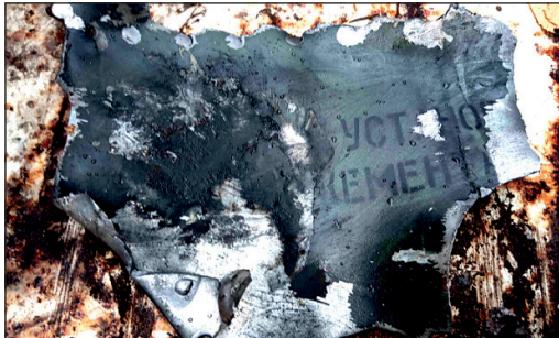
Рис. 10. Марковальні позначення на обшивці паливно-агрегатного відсіку КР Х-101
