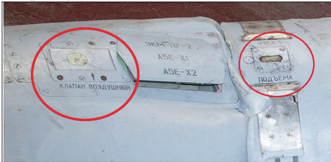
Рис. 2. Марковальні позначення та написи на корпусі КР Х-101
