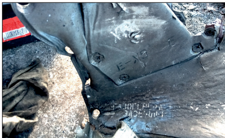
Рис. 6. Марковальні позначення на обшивці хвостового відсіку КР Х-101
