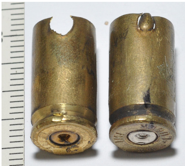
Рис. 9. Вырез в гильзе, образованный в процессе выстрела отверстием для фиксации ствола (гильзы из двух различных экземпляров оружия)
