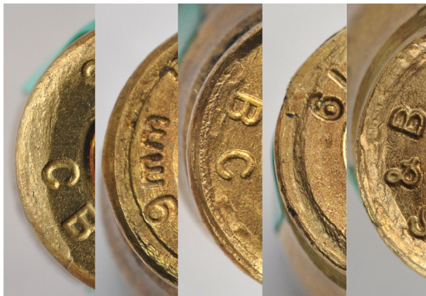
Рис. 5. Отпечаток формы чашечки патронного упора (различные варианты)
