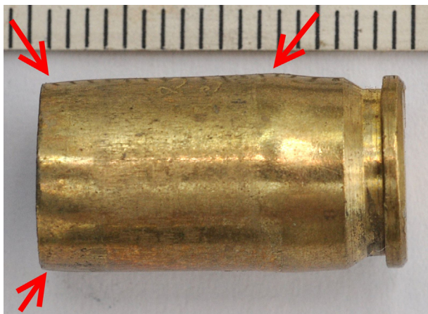
Рис. 6. Деформация гильзы из-за несоответствия формы патронника
