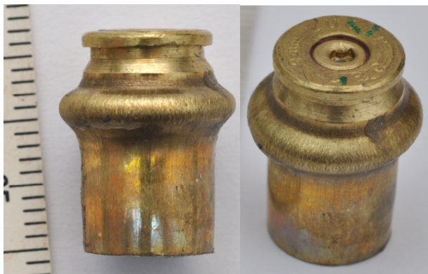
Рис. 7. Раздутие задней части гильзы
