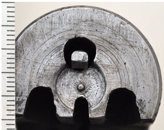
Рис. 2. Лицевая поверхность затвора с чашечкой патронного упора, бойком и зацепом извлекателя
