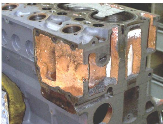
Рис. 1. Зовнішній вигляд продуктів корозії на системі охолодження двигунів внутрішнього згоряння
