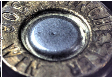
Рис. 10. Збільшене зображення слідів від попередньої завальцювки капсульного гнізда гільзи
