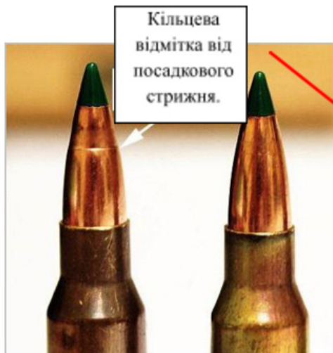
Рис. 14. Збільшене зображення частини патрона з кільцевою відміткою на кулі від посадкового стрижня матриці
