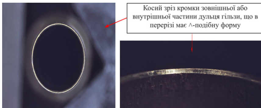
Рис. 4. Збільшене зображення слідів від зняття внутрішньої та зовнішньої фаски на дульці гільзи
