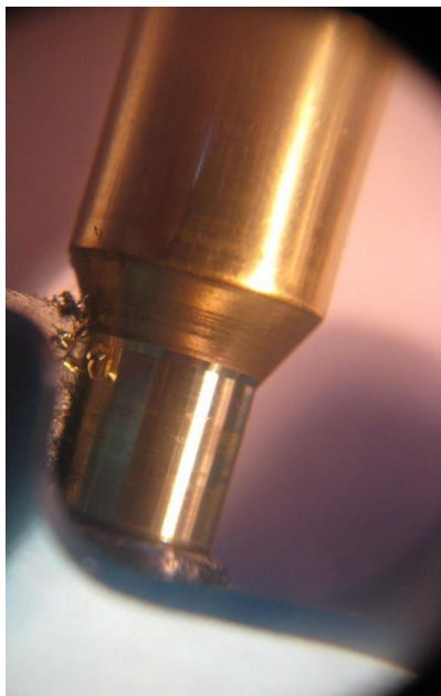
Рис. 6. Збільшене зображення слідів від проточування дульця гільзи
