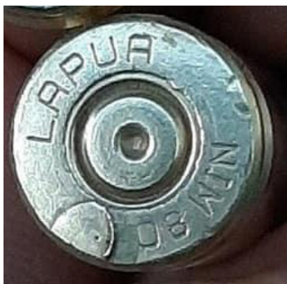
Рис. 18. Збільшене зображення сліду відбивача на денці гільзи
