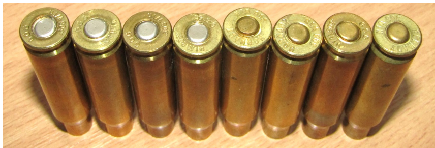
Рис. 11. Зображення гільз із різними варіантами неправильної установки капсуль в капсульне гніздо гільзи
