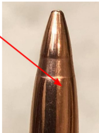
Рис. 15. Збільшене зображення кулі з кільцевою відміткою від посадкового стрижня матриці
