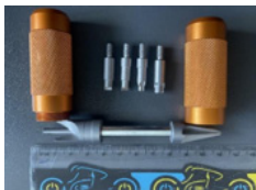
Рис. 12. Зображення універсального інструменту компанії Luman для підготовки гільз (чистка, вирівнювання капсульного гнізда)
