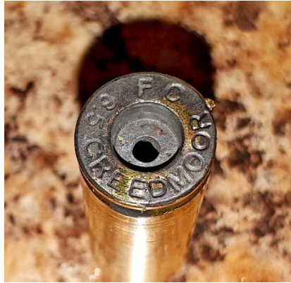
Рис. 20. Збільшене зображення капсульного гнізда на денці гільзи
