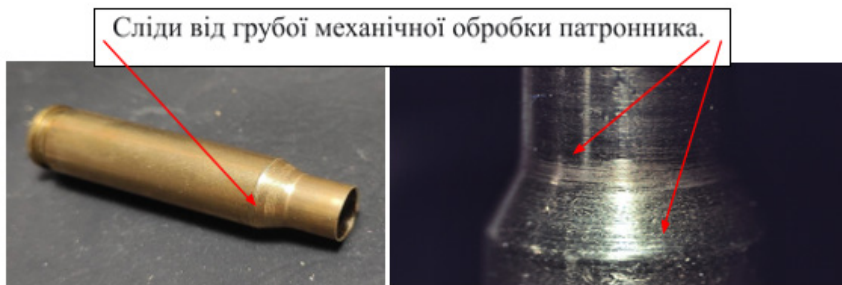
Рис. 2. Зображення слідів грубої механічної обробки патронника, які відобразились на скаті гільзи
