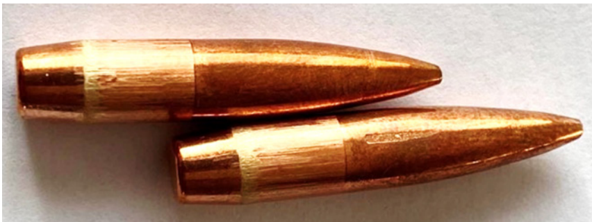
Рис. 21. Збільшене зображення демонтованих куль зі слідами від дульця гільзи
