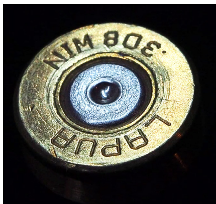
Рис. 19. Збільшене зображення денця гільзи з відкладеннями порохового нагару навколо капсуля
