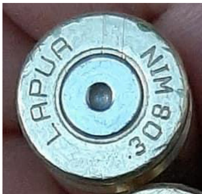
Рис. 16. Збільшене зображення денця гільзи зі сплющеним капсулем
