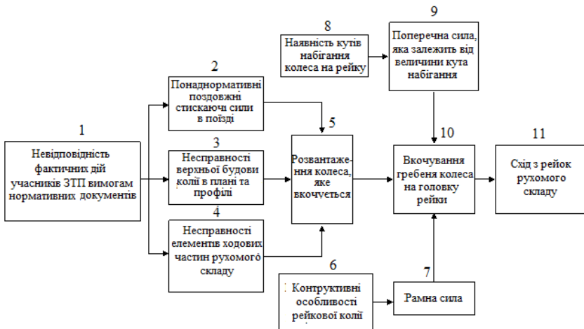
Рис. 1. Приклад побудованого експертом механізму сходу рухомого складу з рейкової колії
