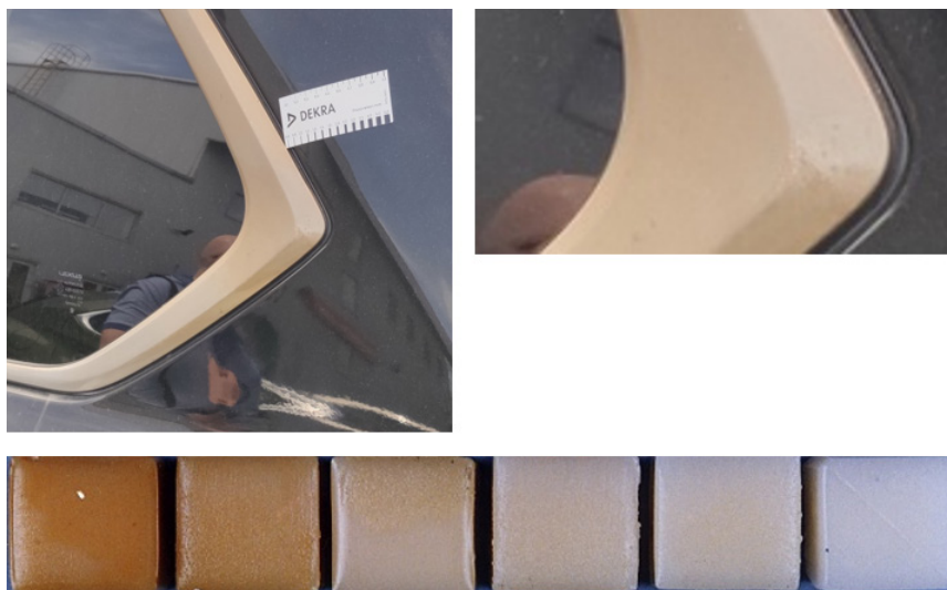
Зображення 12. Порівняння забарвлень, які набула окантовка скла боковини лівої з забарвленням експериментальних зразків
