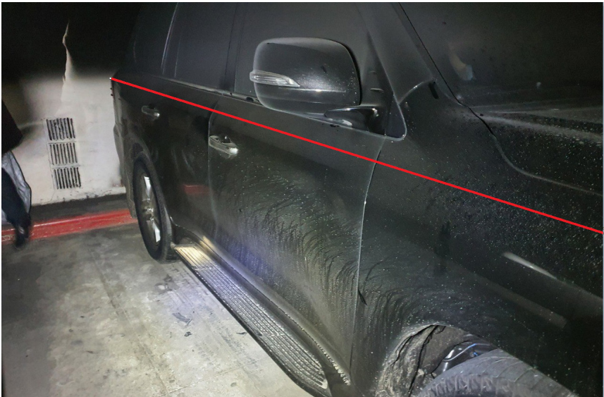
Зображення 4. Фотографія автомобіля LEXUS LX 450d на місці пожежі з зазначенням лінії, на якій під час пожежі температура могла скласти 89 °С
