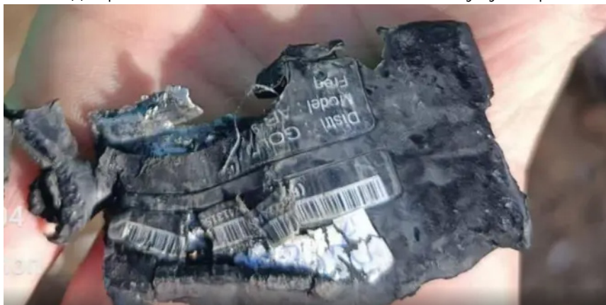
Рис. 1. Залишки пейджера, що належав члену угруповання «Хезболла», після вибуху елементів його живлення (літій-іонних акумуляторів).
