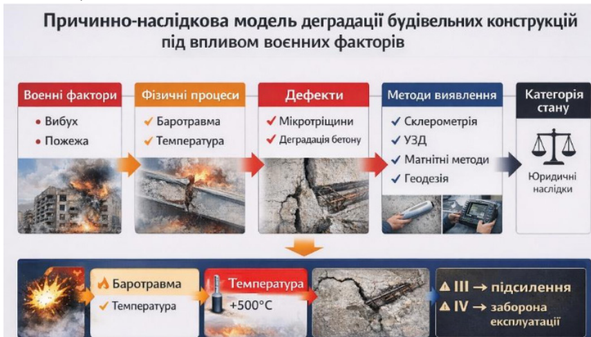
Рис. 8. Причинно-наслідкова модель пошкодження будівельних конструкцій під впливом воєнних факторів (розроблено та візуалізовано автором із застосуванням інструментів ШІ [ChatGPT]).
