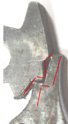
Рис. 4. Збільшене зображення місця взаємодії курка і спускового гачка (червоною пунктирною лінією виділено дефекти кустарної підгонки) (фото з архівних матеріалів кримінального провадження № 12018030060000036)
