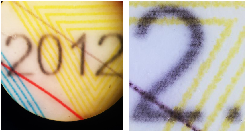
Рис. 7, 8. Збільшені зображення фрагментів маркування у зразку бланку 2012 року, нанесеного з використанням обладнання ЄДАПС-Лазер – Україна
