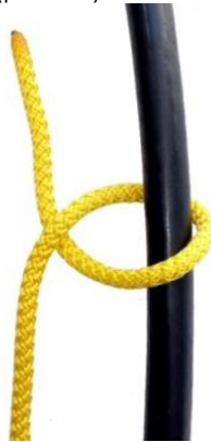
Рис. 10. Зображення обнесення основою вузла предмета з наступним перехрещуванням кінця під прямим кутом
