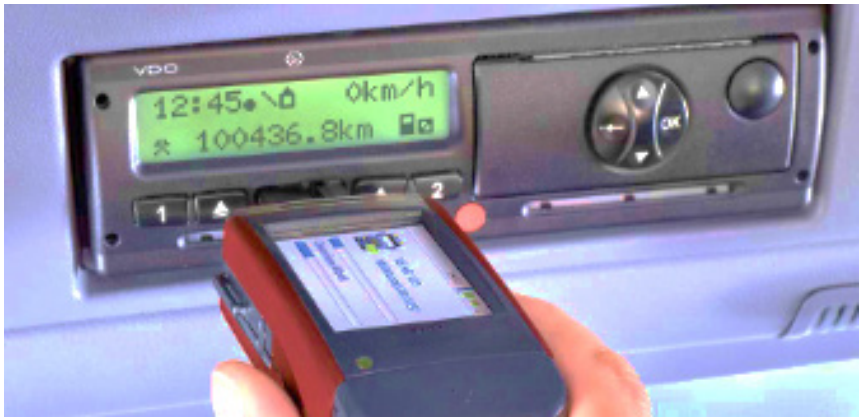
Зображення №5. Зчитування даних із цифрового тахографа 1-го покоління.
