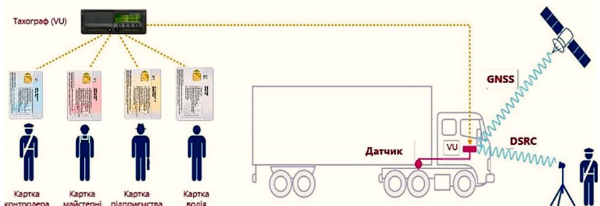
Зображення №2. Схема роботи розумного тахографу [5].
