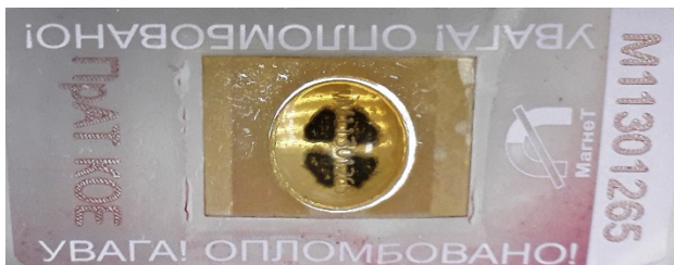
Рис. 21. Зовнішній вигляд деструкції полімерних матеріалів капсули та зв'язуючого компонента від дії ультрафіолетового випромінювання
