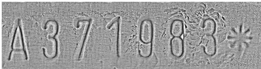
Рис. 2. Виявлення зміни у знаках методом магнітооптичної візуалізації
