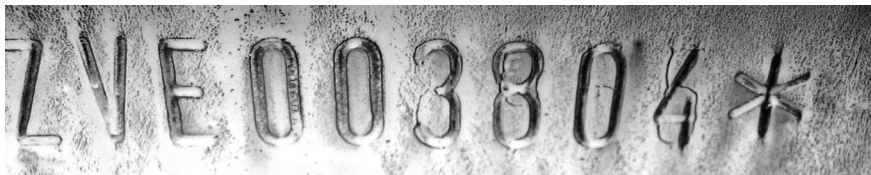
Рис. 1. Вигляд номерного майданчика автомобіля та первинних знаків ідентифікаційного номера, після застосування магнітопорошкового методу
