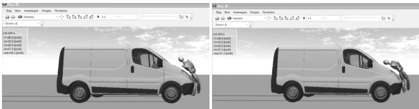
Рис. 1 Фази переміщення пішохода в момент наїзду при швидкості руху 60 км/год, отримано при моделюванні наїзду з використанням програмного комплексу PC-Crash.
