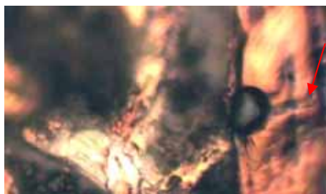
Рис. 1. Мікрочастинка тонера, розташована поверх рукописного штриха, виконаного чорною пастою для кулькових ручок
