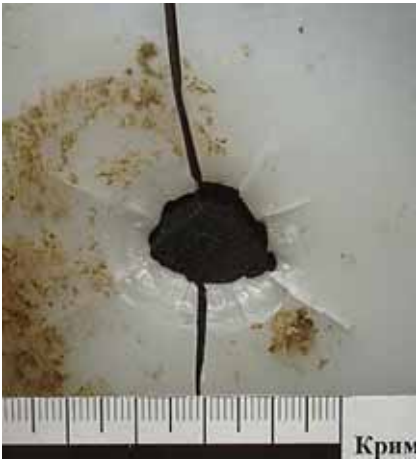
Рис. 10. Наскрізне пошкодження пластини полімерного матеріалу, включно з ефектом «мінус матеріалу» при стрільбі з середньої відстані, 9 мм, короткоствольної вогнепальної зброї під кутом 50-55 градусів (перевищення кута рикошетування).
