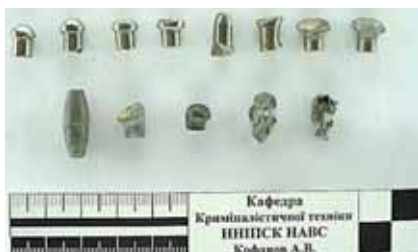
Рис. 6. Види деформації (фрагментації) різновидів сталевих сердечників, свинцевих куль та сорочок при рикошетуванні після пострілу під різними кутами.
