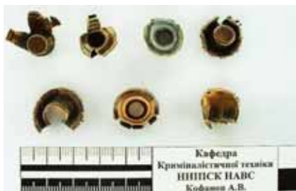
Рис. 5. Фрагментація оболонок куль з повною руйнацією снаряду у цілому при рикошетуванні після пострілу під різними кутами.
