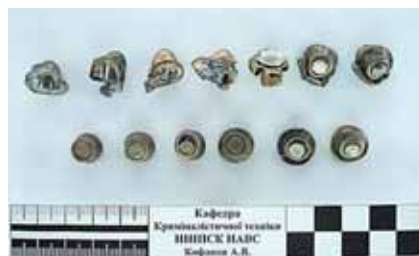
Рис. 3. Суттєва руйнація напів- та оболонкових куль при рикошетуванні після пострілу під різними кутами.
