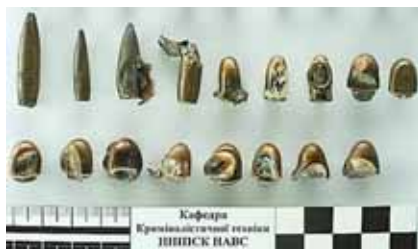
Рис. 2. Часткова руйнація оболонкових куль при рикошетуванні після пострілу під різними кутами.
