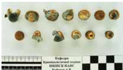
Рис. 4. Руйнація 80% і більше, напів-та оболонкових куль при рикошетуванні після пострілу під різними кутами.
