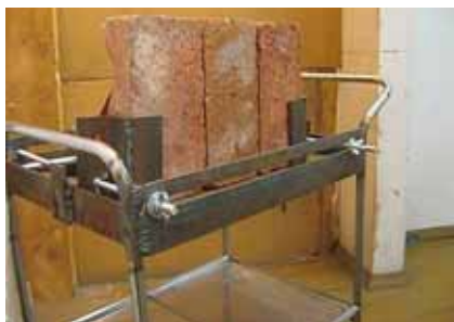
Рис. 1. Прилад моделювання рикошетування вогнепального снаряду у лабораторних умовах (Гусенцов О.О., Артюшин О.А., Данилова В.А.)
