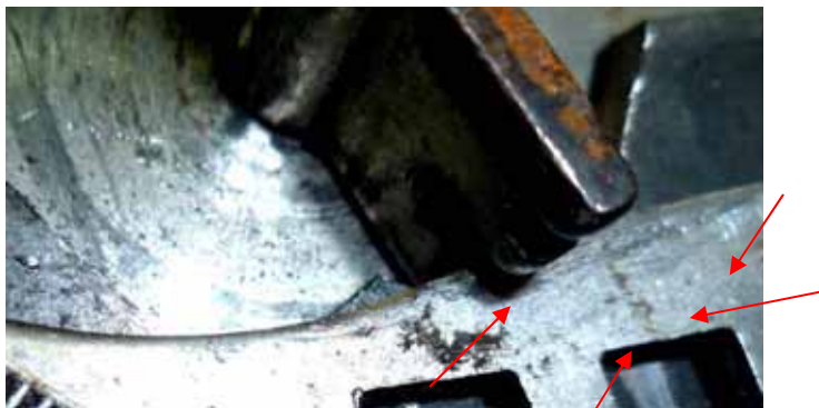
Рис. 11. Співставлення робочого елемента борідки ключа № 1 із експлуатаційними потертостями на сувальді № 5 замка.
