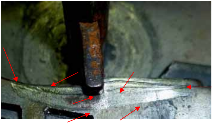
Рис. 9. Співставлення робочого елемента борідки ключа із експлуатаційними потертостями на сувальді № 2 замка.
