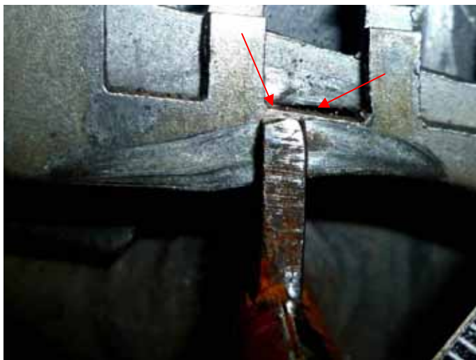
Рис. 14. Співставлення робочого елемента борідки ключа № 4 із експлуатаційними потертостями на сувальді № 2 замка № 1.
