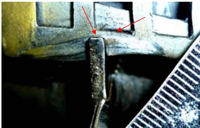
Рис. 13. Співставлення робочого елемента борідки ключа № 3 із експлуатаційними потертостями на сувальді № 2 замка № 1.
