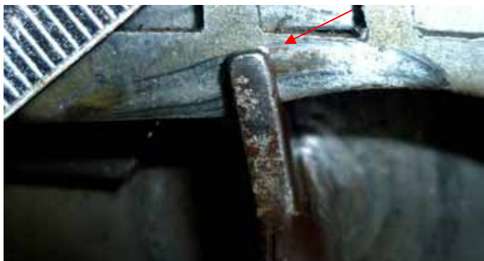
Рис. 12. Співставлення робочого елемента борідки ключа № 2 із експлуатаційними потертостями на сувальді № 2 замка № 1.
