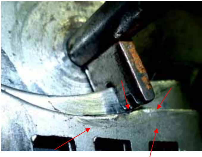
Рис. 10. Співставлення робочого елемента борідки ключа № 1 із експлуатаційними потертостями на сувальді № 4 замка.
