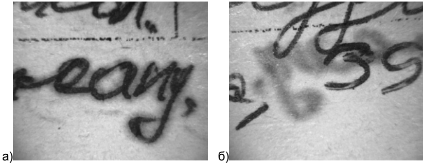
Рис. 1. Фрагменти записів в документі, в яких спостерігаються розпливи барвної речовини (а), в тому числі з просоченням на зворотну сторону аркуша (б).
