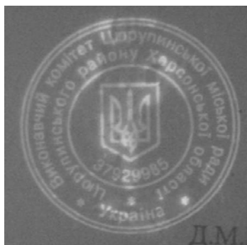
Рис. 6. Відтиск печатки в досліджуваному документі в ІЧ-зоні спектру при збудженні зеленим світлом, в якому спостерігається нерівномірна люмінесценція штрихів.
