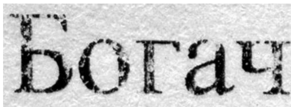
Рис. 4. Фрагмент друкованого тексту в досліджуваному документі, в якому спостерігається обсіпання тонеру.
