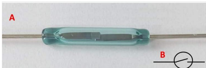
Рис. 1. А) Зовнішній вид геркона; В) позначення на принциповій схемі.
