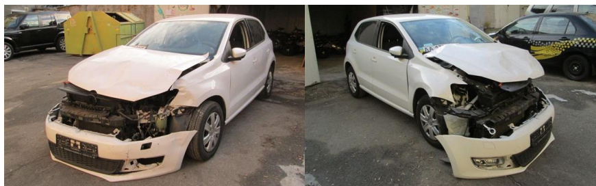
Рис. 1, 2. Загальний вигляд на пошкодження передньої частини кузова та облицювань досліджуваного автомобіля
