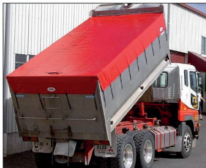
в) Тентова конструкція, облаштована на кузові самоскида
