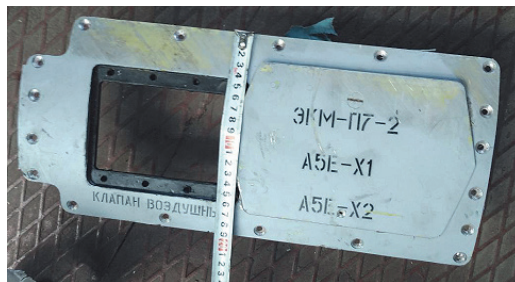
Рис. 3. Марковальні позначення та написи на кришці люку доступу до електророзривного роз'єму паливно-агрегатного відсіку КР Х-101
