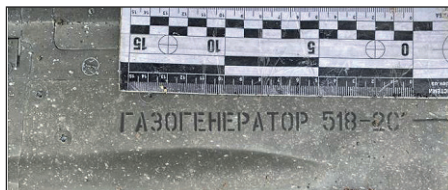
Рис. 8. Марковальні позначення на обшивці аеродинамічних ролів КР Х-101
