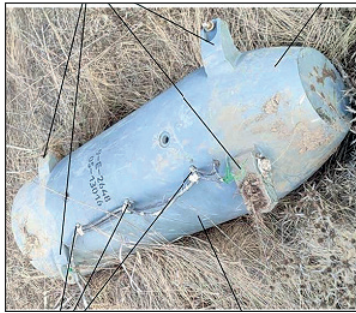
Рис. 11. Марковальні позначення на бойовій частині КР Х-101
