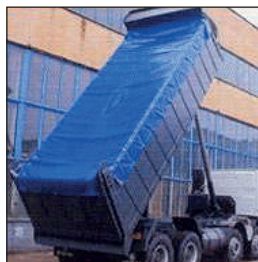
Рис. 1. Тентова конструкція напівпричепа із скручувальною корбою
