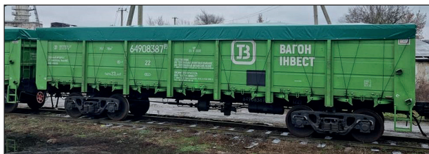
а) Тентова конструкція на залізничному піввагоні, який перевозить зерно
