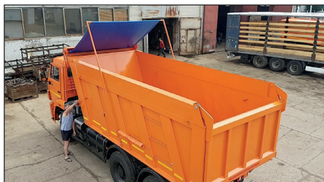
Рис. 1. Тентова конструкція напівпричепа із скручувальною корбою
