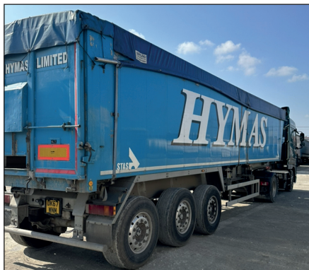
Рис. 1. Тентова конструкція напівпричепа із скручувальною корбою
