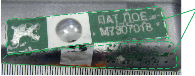
Рис. 2. Збільшене зображення слідів порушення цілісності та повторного встановлення пломби-наклейки індикатора магнітного поля
