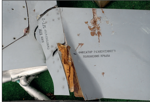
Рис. 9. Марковальні позначення на обшивці паливно-агрегатного відсіку КР Х-101
