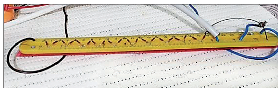
Рис. 3. Резисторний подільник напруги (макетний зразок)
