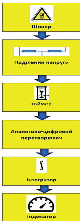
Рис. 2. Блок-схема для визначення характеристик ЕШП
