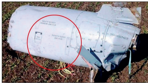
Рис. 7. Марковальні позначення на обшивці хвостового відсіку КР Х-101
