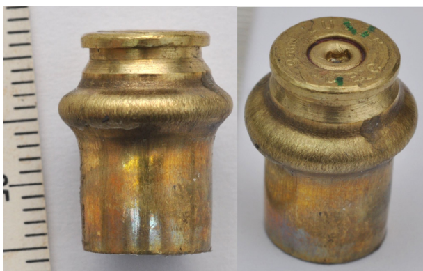
Рис. 7. Раздутие задней части гильзы
