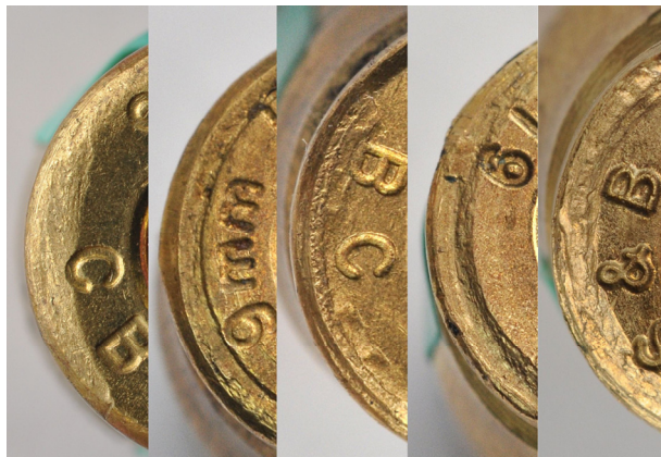
Рис. 5. Отпечаток формы чашечки патронного упора (различные варианты)
