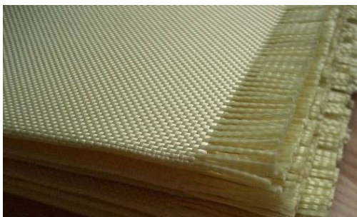
Рис. 11. Загальний вигляд на полотно п-арамідної тканини – кевлару
