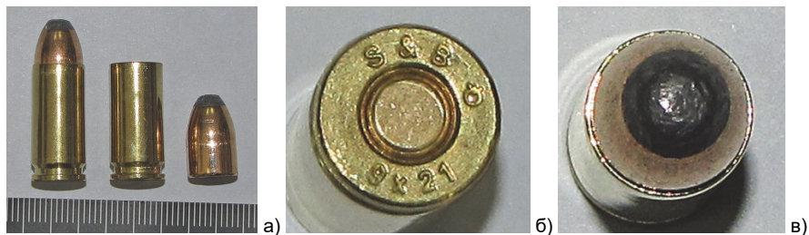
Рис. 6. Загальний вигляд та елементи спорядження пістолетних патронів калібру 9×21 мм виробництва чеської фірми «S&B», споряджених експансивною кулею типу «SP» масою 8,0 г. (поз. а); маркувальні позначення патрона (поз. б); вид головної частини кулі (поз. в)
