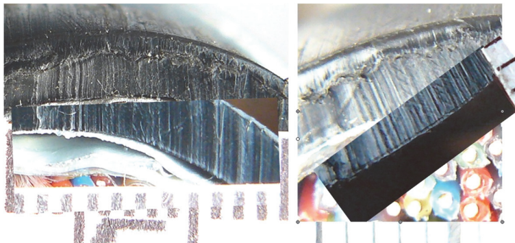
Рис. 3. Суміщення трас у слідах розрізу, утворених труборізом
