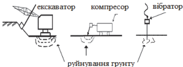
Рис. 3. Зміни властивостей ґрунту при використанні будівельної техніки
