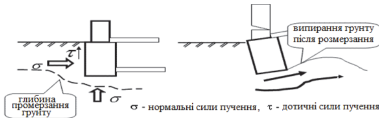
Рис. 6. Зміни властивостей ґрунтової основи внаслідок морозного пучення
