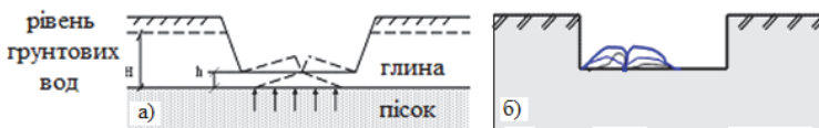
Рис. 5. Зміни структури котловану при виконанні земельних робіт внаслідок гідростатичного впливу (а) та механічної суфозії (б)
