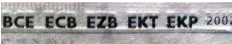
Рис. 10 . Суміщені друковані штрихи та штрихи безкольорового рельєфного відтиску
