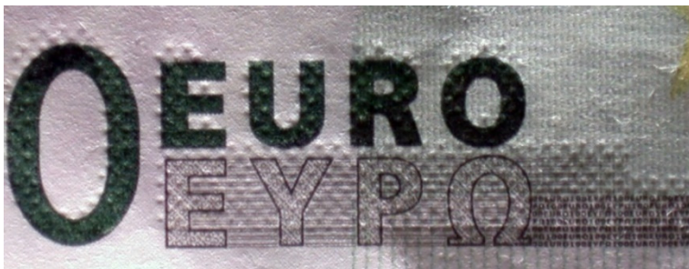
Рис. 14. Зразок імітації рельєфних елементів на підробленій банкноті 100 євро
