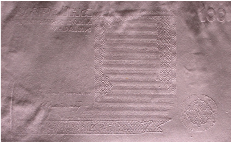
Рис. 8. Експериментальний зразок безкольорового рельєфного відтиску елементів лицьового боку банкноти
