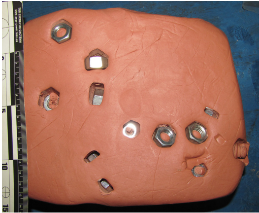
Рис. 14. Характер ураження блоку балістичного пластиліну при стрільбі гайками М8, М10 та М12
