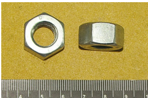
Рис. 10. Загальний вигляд гайки М12, яка використовувалась для експериментальної стрільби з рогаток
