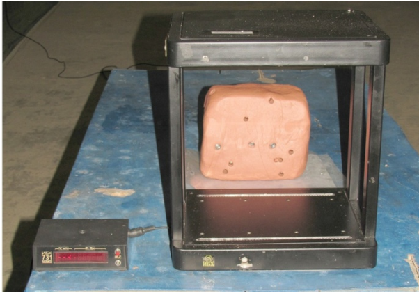
Рис. 4. Загальний вигляд оптоелектронного вимірювального комплексу «ИБХ-731», який був використаний для визначення початкових швидкостей кінетичних снарядів, вистріляних із рогаток
