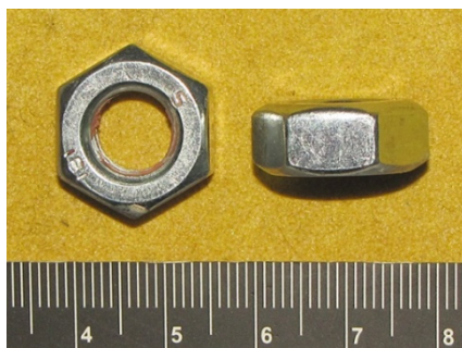
Рис. 9. Загальний вигляд гайки М10, яка використовувалась для експериментальної стрільби з рогаток
