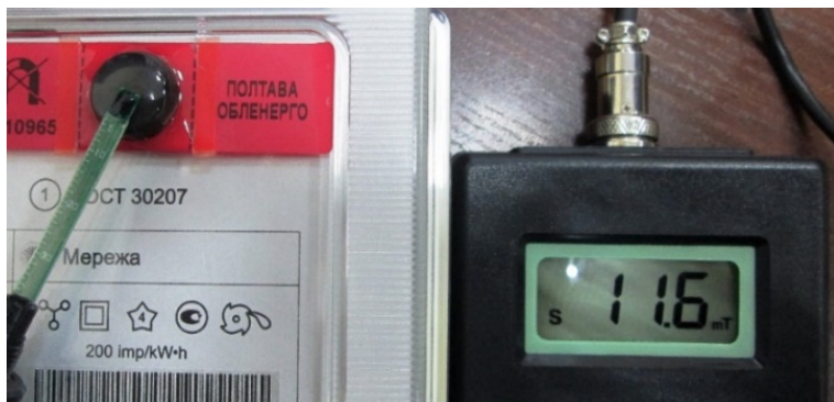
Рис. 20 Вимірювання значення залишкової індукції чутливого елемента ІМПЗП.
