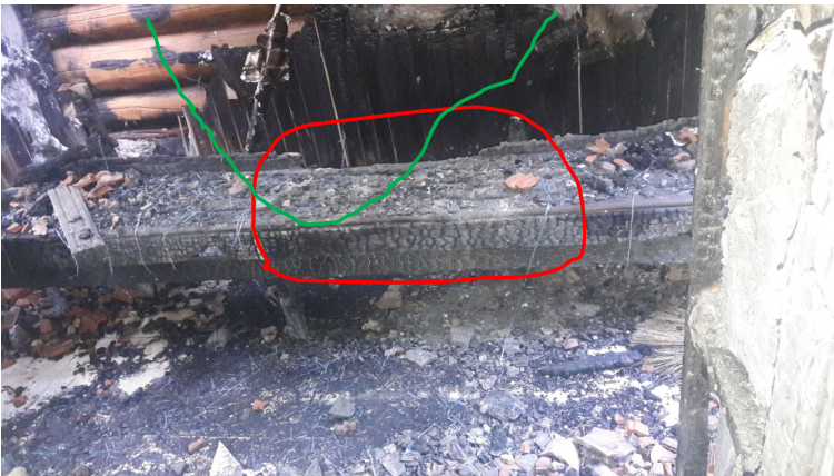
Рис. 2. Місце первинного горіння (осередок пожежі – червоний контур), який був обумовлений загорянням бавовняної (простирадло) тканини залишеної на деревяному лежку парильного відділення сауни сухого жару. Лінія зеленого кольору – контур висхідного потоку газоподібних продуктів горіння
